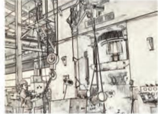
Раздаточный пресс для тройников 5 000 тонн
